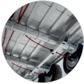
Extrem starke Bodenunterstützung durch viele Rohrprofile
