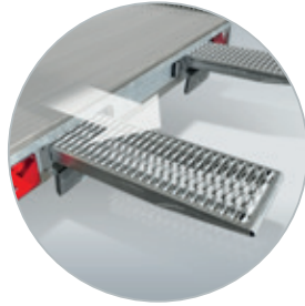
Stahl Auffahrampen von 250 cm in Kassette
