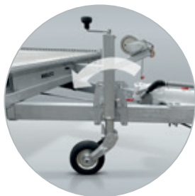
Zubehör: Klappbares Stützrad ermöglicht Weiterfahrt
