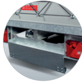
Serienmäßig mit integrierten Halterungen für Auffahrampen ausgestattet
