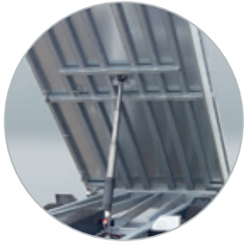
Robuste Stabilisierung der Ladefläche durch Kastenprofile
