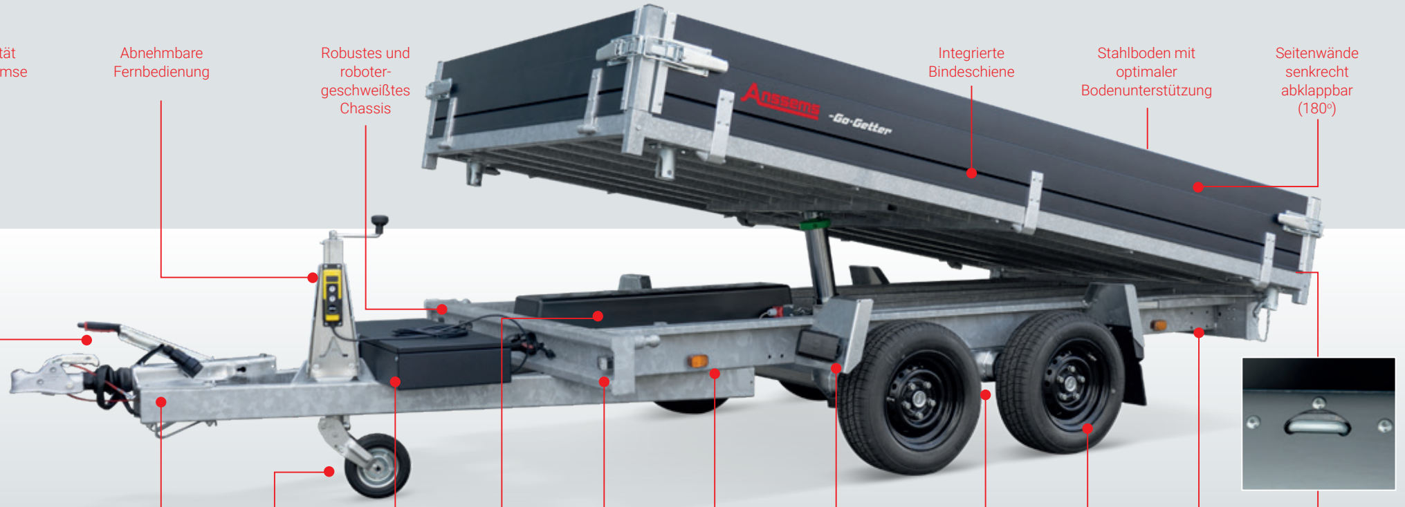
Lange Deichsel aus Rechteckrohrprofilen
