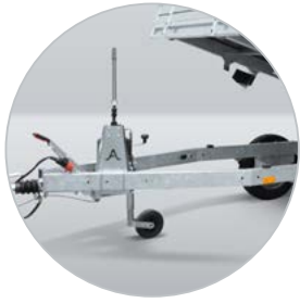
Deichselprofile führen bis zur Rückseite der Ladeplattform
