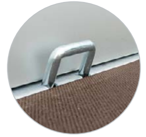
8 Bindehaken an der Innenseite der Ladeplattform
