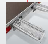
Unterm Ladeboden integrierte Auffahrampen
