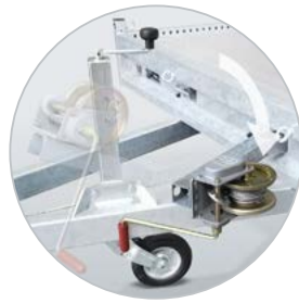
Zubehör: Seilwinde mit Stütze
