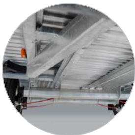
Extrem stabiles Fahrgestell mit optimaler Bodenunterstützung
