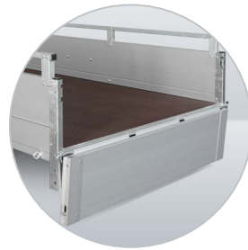
Rückwand komplett klappbar + abnehmbar
