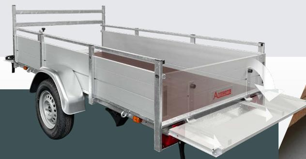
Rückwand kann auf ausziehbaren Rohren abgestützt werden.
