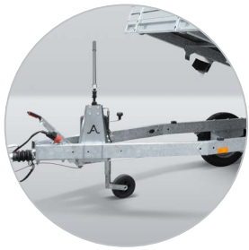
Deichselprofile führen bis zur Rückseite der Ladeplattform
