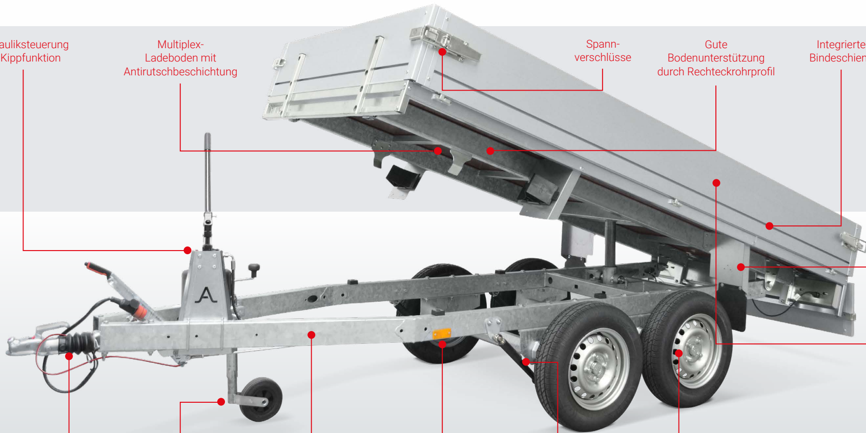
Deichselprofile führen bis zur Rückseite der Ladeplattform
