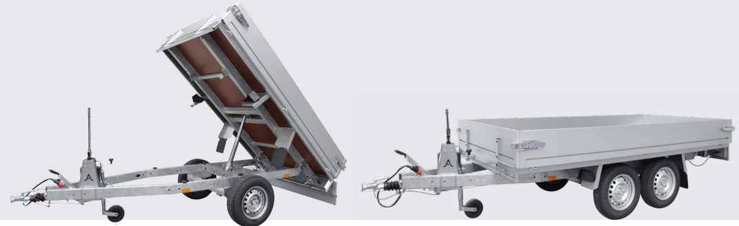
KLT Einachser gebremst mit Handpumpe
