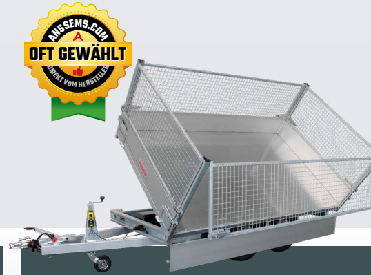
Ein KSX mit einem Gitteraufsatz von 70 cm bietet die Möglichkeit, zusätzliches Volumen zu transportieren. Auch hier beträgt die Ladehöhe 100 cm.
