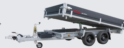
KSX Go-Getter 3-Seitenkipper elektrische Pumpe
