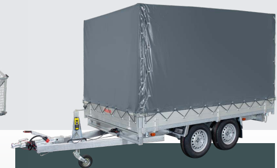
Anssems PSX Hochplane mit Gestell, Höhe 180 oder 200 cm. Die dazugehörige Plane wird komplett mit Expanderseil und Netzhaken Satz geliefert.
