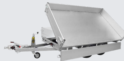
KSX Rückwärtskipper oder 3-Seitenkipper elektrische Pumpe
