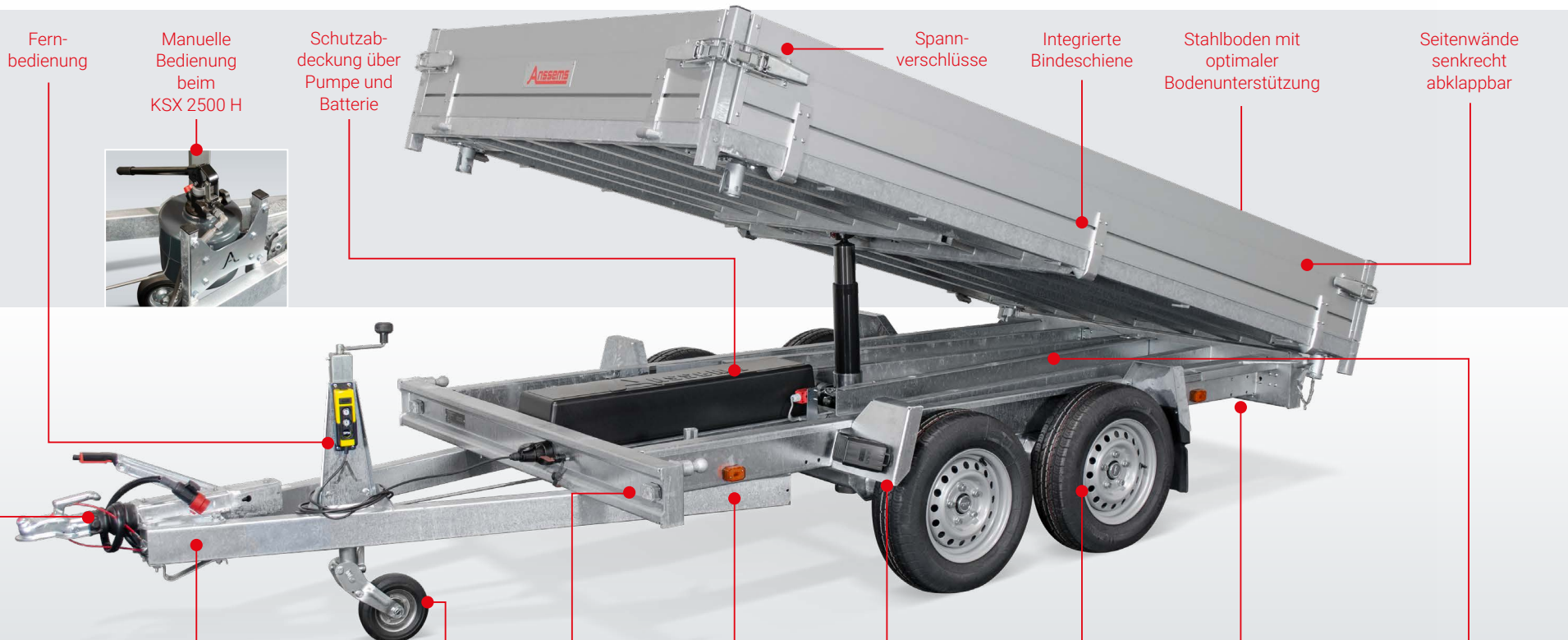
Lange Deichsel aus Rechteckrohrprofilen
