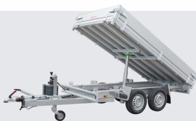
KSX Rückwärtskipper oder 3-Seitenkipper Handpumpe
