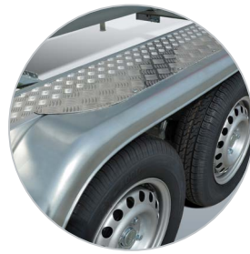
Kotflügel mit extra Verstärkung
