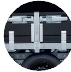
Geteilte Seitenwände mit Integrierte Bindschiene
