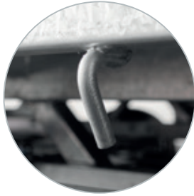
Lange Verzurrhaken unter dem Ladeboden
