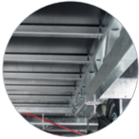
Robustes Profichassis aus Rechteckrohrprofilen
