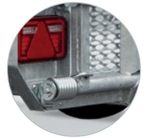
Heckklappe mit Torsionsfedern
