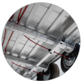
Support de plancher extrêmement robuste grâce aux nombreux profils tubulaires
