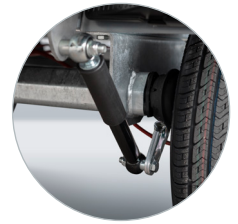
Zubehör: Achsstoßdämpfer für zusätzlichen Fahrkomfort
