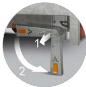
Accessoire: eenvoudig te bedienen steunpoten
